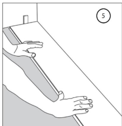
Начинайте укладку слева направо (рис. 5), от сплошной стены помещения, поместив первую доску продольным шипом к стене (рис. 6). Расстояние между досками и стеной можно отрегулировать с помощью клиньев позже, когда будут уложены три или четыре ряда.
