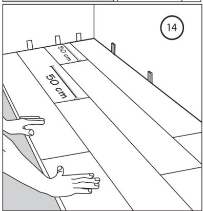
доске, под углом к ней (рис. 7), и осторожно опустите эту доску на пол, вводя при нажатии шип в паз. Продолжайте укладку этим способом до конца первого ряда.
