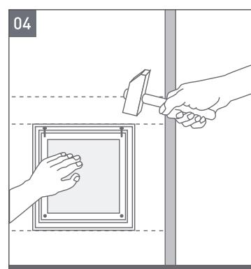
**5** Приложите изделие к стене, плотно прижимая его к поверхности, зафиксируйте при помощи саморезов. Саморезы необходимо вкрутить, слегка утопив их в само изделие, а затем зашпатлевать отверстия.
